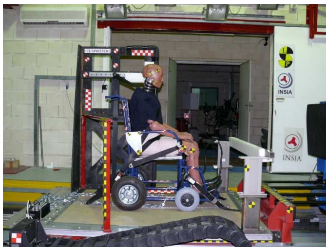
Fig 3: Ensayo de verificación de la resistencia de los sistemas de retención para PMR (²).
